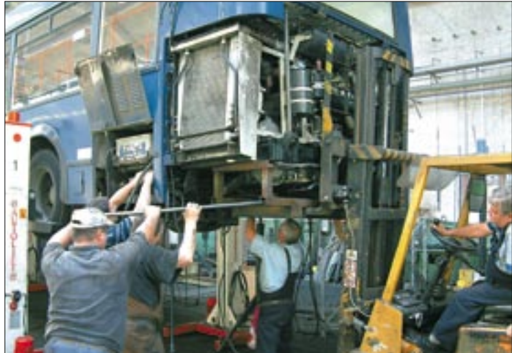
Mi kerülhet itt kétfélmillióba? A szigetelés után beemelik a helyére a busz motorját
