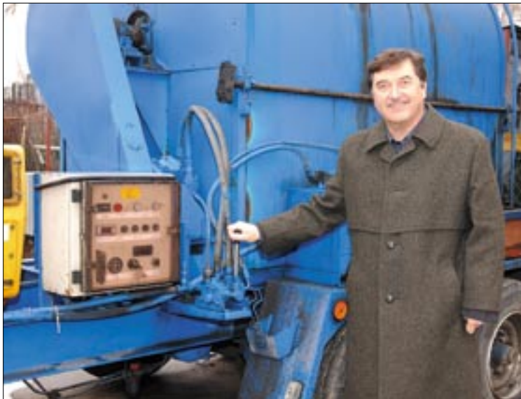
Krompaszky András és a most vásárolt öntöttaszfalt-főző és -melegen tartó gép
